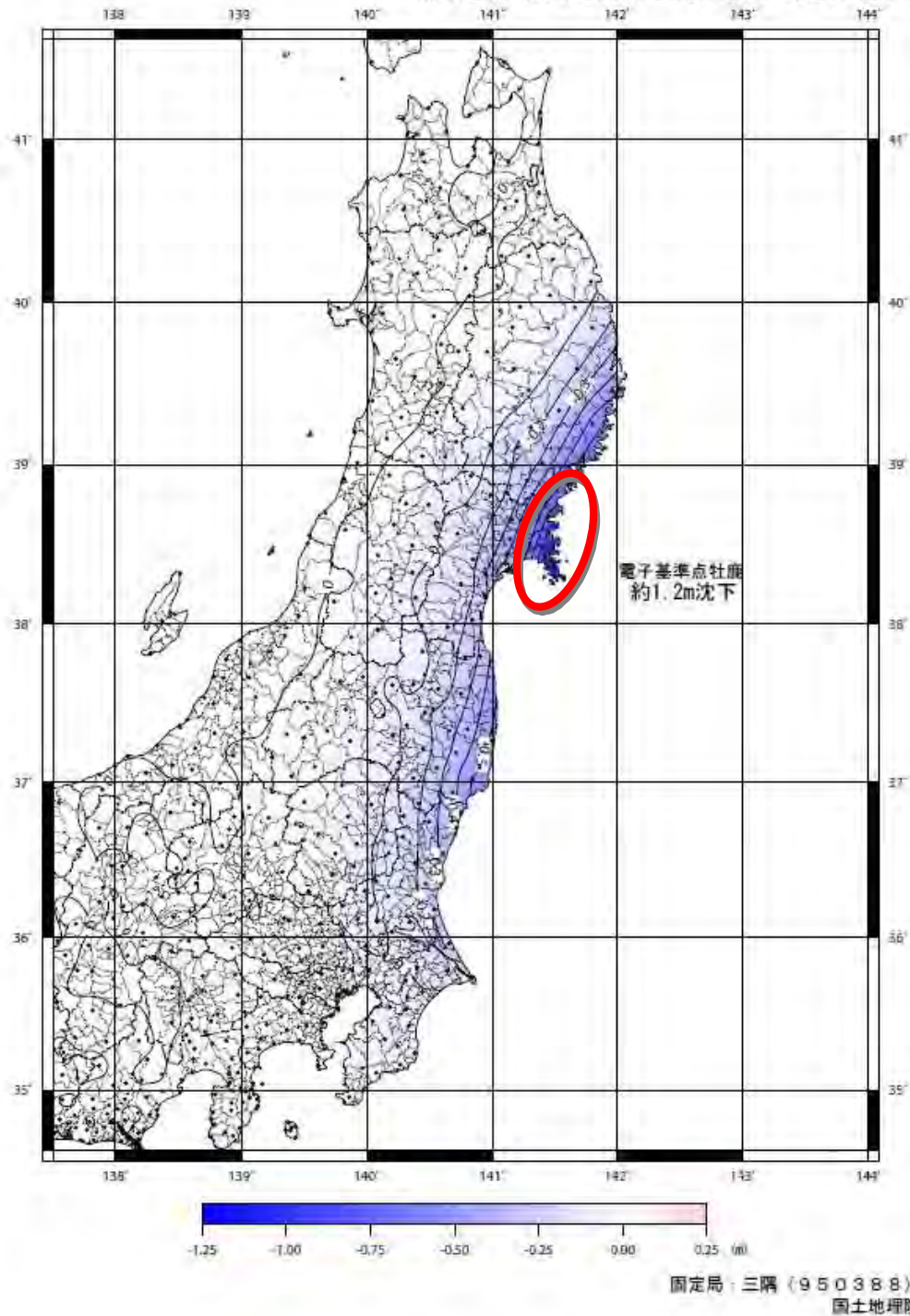
図 2 . 地殻変動量 . 国土地理院 ( 2011 , http://www.gsi.go.jp/common/000059956.pdf ) に よる図に今回の調査地域を赤丸で示す .
